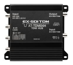
最大4本のEX-SDIまたはHD-SDI信号をTDM信号に変換し、同軸ケーブル1本で複数映像信号を多重伝送します。
